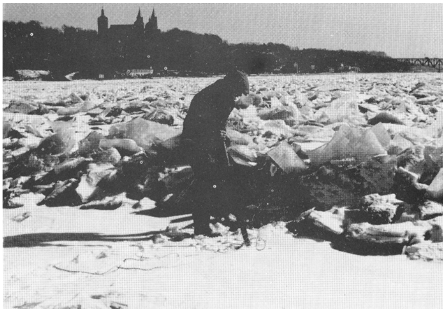
Fot.1. Czoło zatoru śryżowo-lodowego w Płocku (km 633,5, marzec 1987 r. Wysokość czoła ok. 1,5 m, miąższość mas lodu w rejonie czoła ok.5 m [40]
