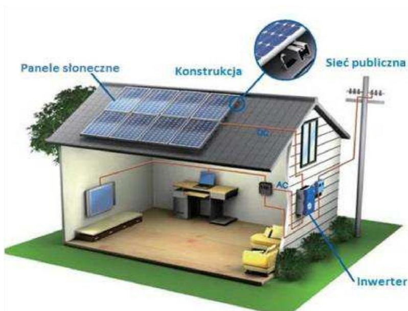
Rysunek 2. Podłączenie systemu fotowoltaicznego do sieci.
