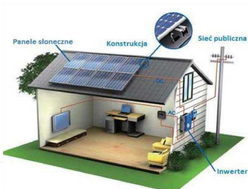
Rysunek 2. Podłączenie systemu fotowoltaicznego do sieci.
