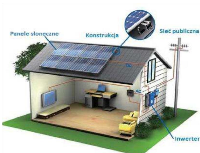
Rysunek 2. Podłączenie systemu fotowoltaicznego do sieci.
